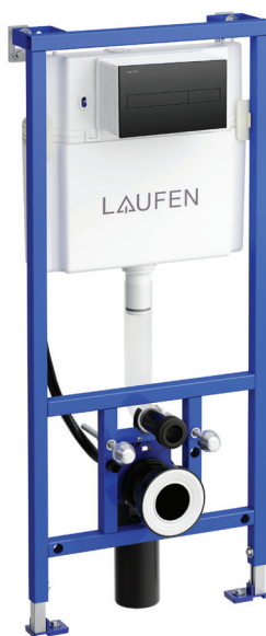
Rámový podomietkový modul CW2, so zabudovanou hadičkou pre prívod vody do ľahkej priečky pre závesné WC Dual Flush 4,5/3 l, nastaviteľné aj na 6/3 l a 4/2 l* H8946660000001
