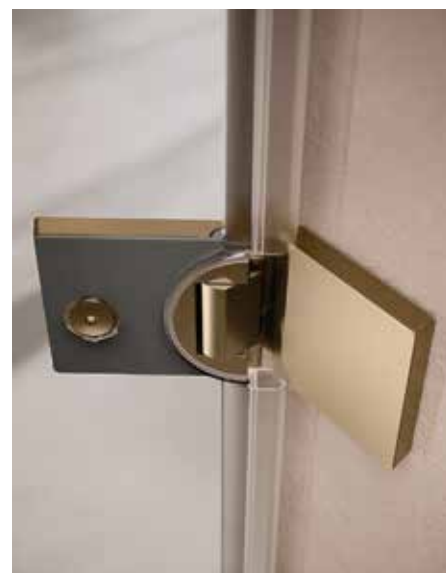
Zdvíhací/spúšťač mechanizmus – teraz diskkrétne skrytý – mierne nadvihne dvere pri otváraní. Tým sa šetrí spodné tesniace lišty a zabezpečí sa takmer automatické zatváranie dverí. Farba: bronzová (možnosť objednávania prostredníctvom kódu farby 55D)
